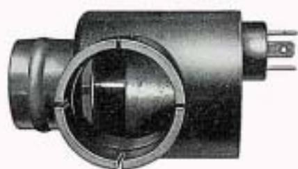
Das Brennluftventil begrenzt die Luftmenge bei kleiner Heizleistung (Pumpe 1). Bei Normalbetrieb öffnet das Ventil und gibt den gesamten Querschnitt frei. Damit wird immer ein exaktes Gemisch aufbereitet.
