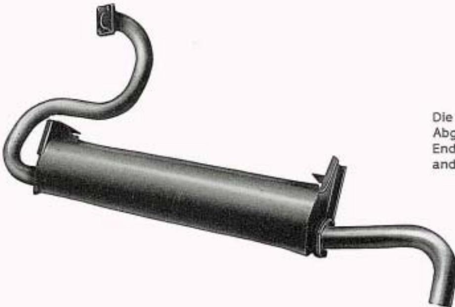
Die Abgasanlage besteht aus Abgasrohr, Schalldämpfer und Endrohr. Die Teile sind miteinander verschraubt.
