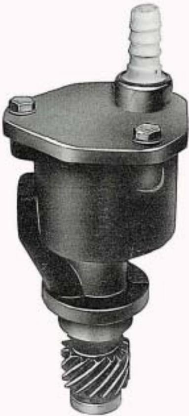
Der Unterdruck für die Bremskraftverstärkung wird durch eine Flügelzellenpumpe erzeugt. Im Pumpendeckel ist ein Ölabscheider, der verhindert, daß Öl in den Bremskraftverstärker gelangt.
