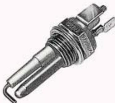
Die Glühzündkerze heizt das Gemisch auf und zündet es. Die Glühkerze darf keine höhere Spannung als ca. 11,5 V bekommen. Im Kabelstrang für Relais ist deshalb ein 5 m langes Widerstandskabel eingearbeitet. Dadurch wird die Reglerspannung für die Kerze auf ca. 11,5 V gesenkt.
