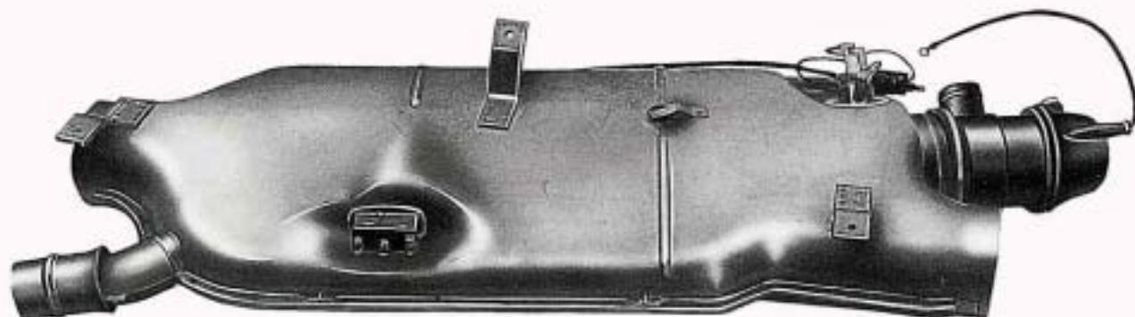
Die dieselektrische Heizung DA 6 ist eine Weiterentwicklung der bekannten benzinelektrischen Heizung BA 6.
